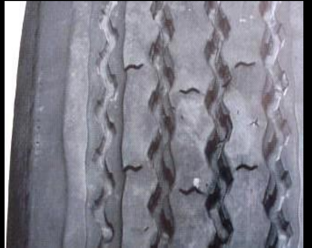
Tipik nehir aşınma, düz tip lastiklerde, virajların az olduğu düz yollarda oluşur.
