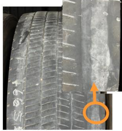
Resim 2: Sırt tabanı (base kısmı) görünen lastik.
